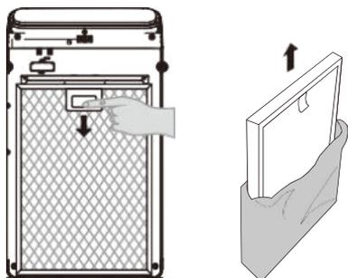
Nehmen Sie die Filter heraus, indem Sie am entsprechenden Streifen ziehen, und entfernen Sie alle Verpackungsbeutel von den Filtern.
