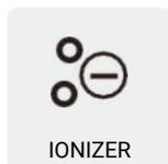
Drücken Sie die ‚IONIZER‘-Taste, um die Ionisationsfunktion ein- und auszuschalten. Das Symbol leuchtet wiederholt auf, solange es aktiv ist. Der Lüfter schaltet sich ein und verbleibt auf niedriger Lüfterstufe, wenn Sie diese Taste im Standby-Modus drücken.
