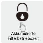
Während das Gerät läuft, können Sie die ‚CHILD LOCK‘-Taste 5 Sekunden lang drücken, um die kumulierte Betriebszeit des Filters auf dem Display anzeigen zu lassen. Die Anzeige verschwindet nach 3 Sekunden.
