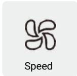
Die Lüfterstufe kann auf niedrig (500 U/min), mittel (700 U/min) oder hoch (900 U/min) eingestellt werden. Die aktuelle Stufe wird auf dem Anzeigefeld angezeigt. Wenn Sie die Taste drücken, während die höchste Stufe aktiviert ist, wird die Lüfterdrehzahl wieder auf die niedrigste Stufe umgeschaltet. Wenn Sie die ‚SPEED‘-Taste verwenden, wird der Automatikmodus deaktiviert.
