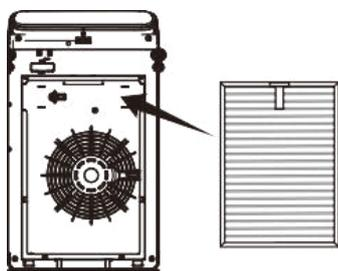
Installieren Sie Filter 3 (Kombifilter HEPA-13 & antibakteriell)
