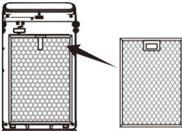
Installieren Sie Filter 1 (Vorfilter)
