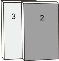
2 Kombifilter Aktivkohle & Katalysator
